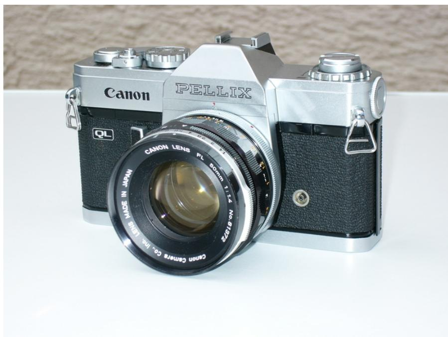
La cellule du PELLIX est située sur le plancher de la cage reflex et ne se relève que pour la mesure de l'exposition, qui se fait par action du doigt sur le levier du retardateur. Ceci a aussi pour conséquence de fermer le diaphragme à la valeur présélectionnée, que l'objectif soit un FL ou un FD ultérieur (le PELLIX reste donc pleinement utilisable à pleine ouverture, même si l'on se munit des excellents objectifs FD).
